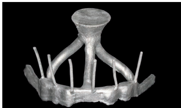
Abb. 58: Lunkerfreie Stahlretention nach dem Abstrahlen.
