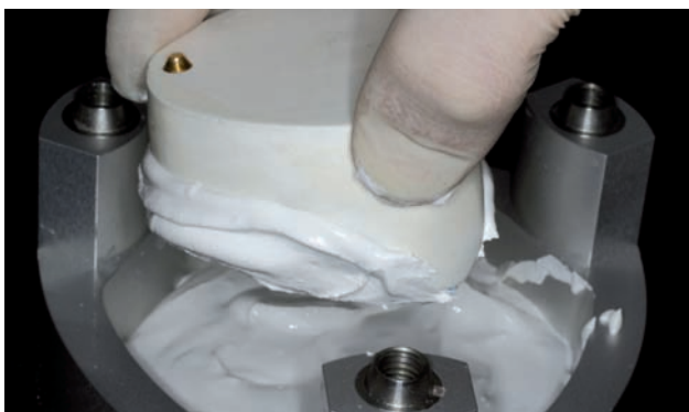
Abb. 61: Einbetten in eine Spezialküvette. Es ist darauf zu achten, dass die Einser mittig zu einem der drei Zentrierzapfen ausgerichtet sind.
