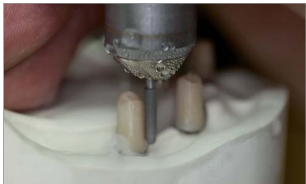
Abb. 12: Nachfräsen der gesinterten Zirkonaufbauten auf 2°.
