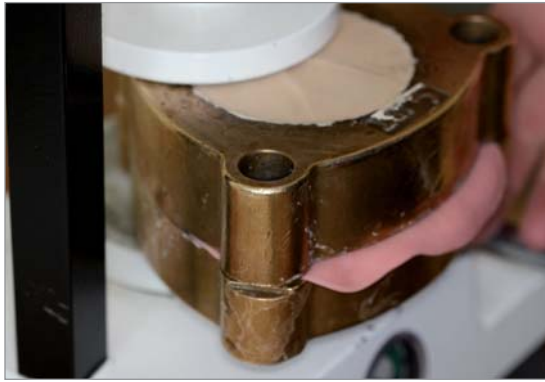
Abb. 30: Pressen mit der JST Kuvette von Candolor.
